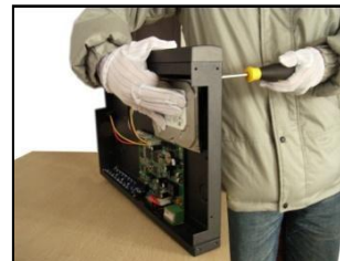
3. закрутите винты жесткого диска
