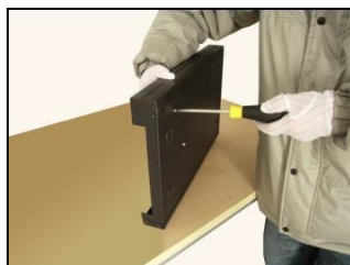
4. закрутите винты жесткого диска
