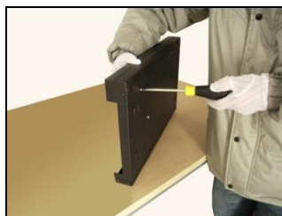
4. закрутите винты жесткого диска
