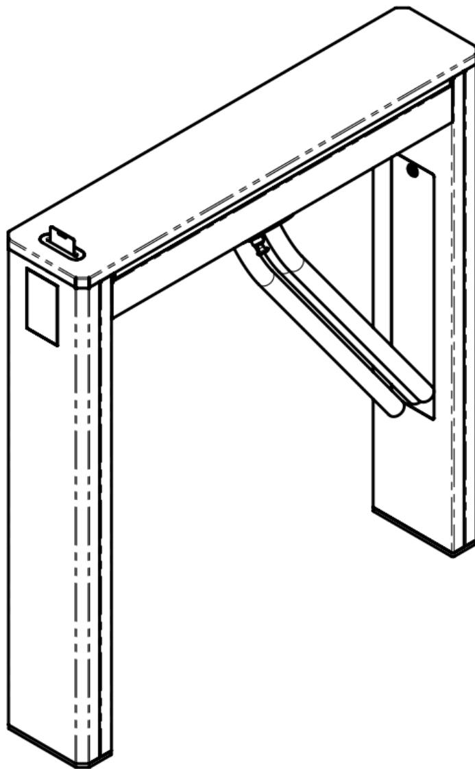
Рисунок 7 – Вид турнкета со сложенными планками
