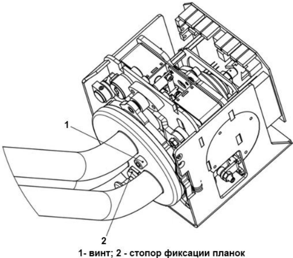
Рисунок 13 – Демонтаж узла преграждающих планок
