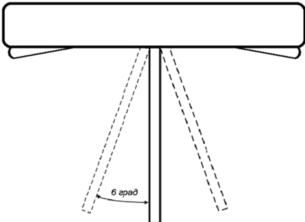
Рисунок 3 – Возможный свободный ход планки в режиме «STOP»
