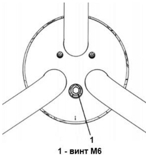
Рисунок 12 – Винт M6 стопора фиксации планок
