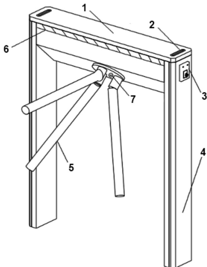
1 - верхняя крышка; 2 - щель картоприемника; 3 - считыватель;
