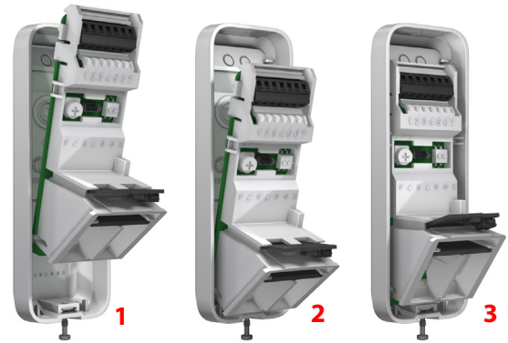
Рисунок 5 – Установка основного блока
