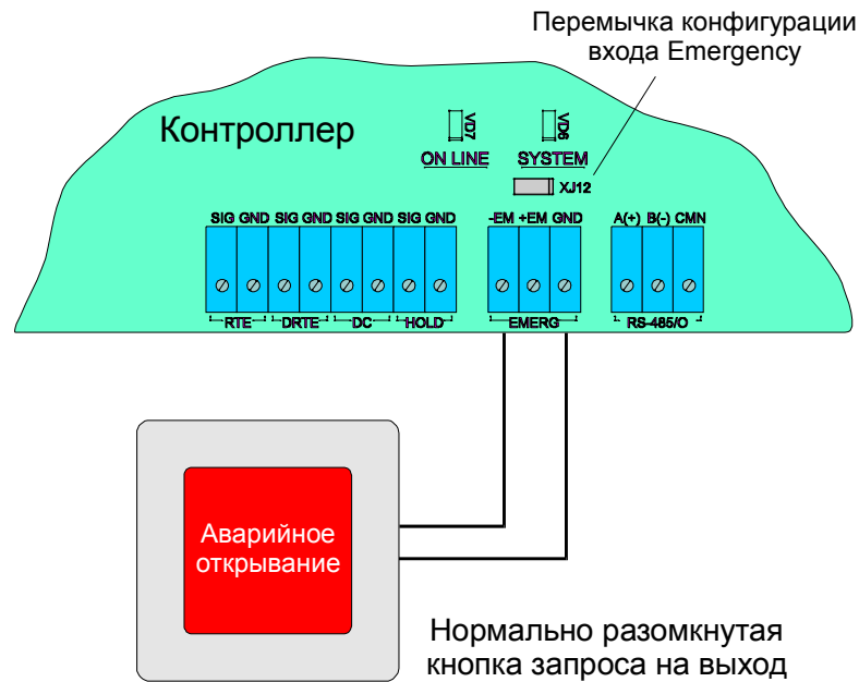
Рис. 13. Подключение аварийной кнопки к одному контроллеру
