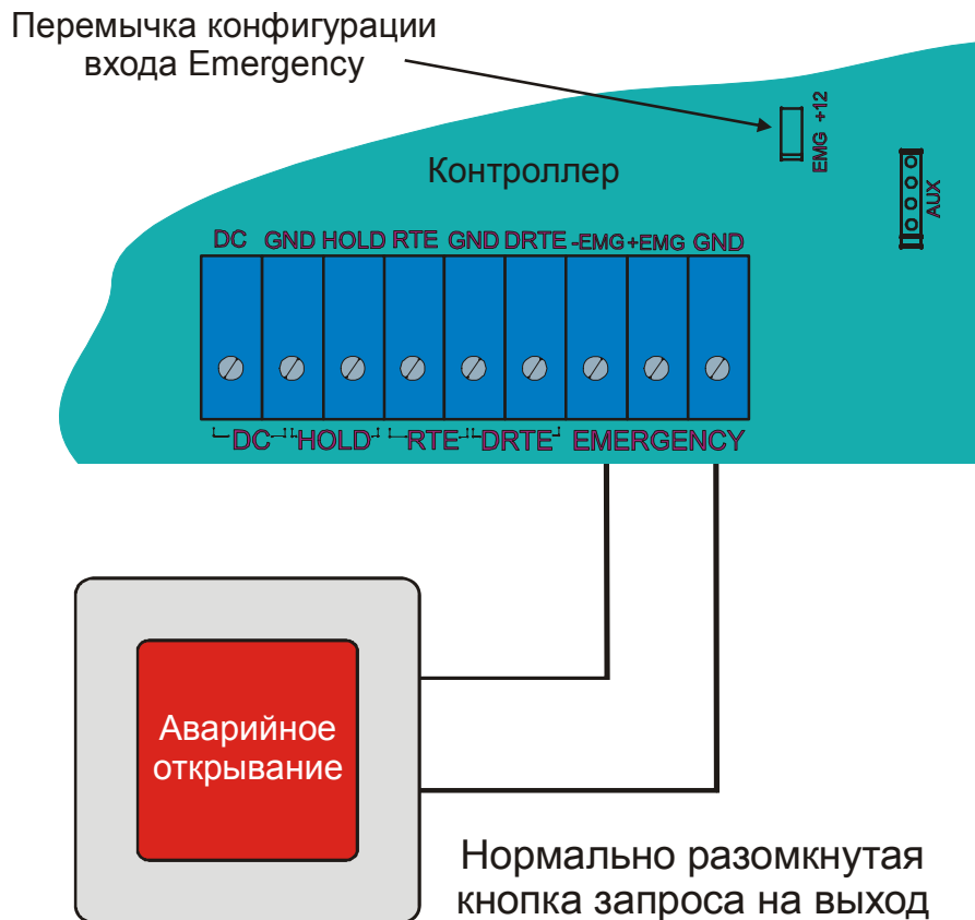
Рисунок 13. Подключение аварийной кнопки к одному контроллеру.
