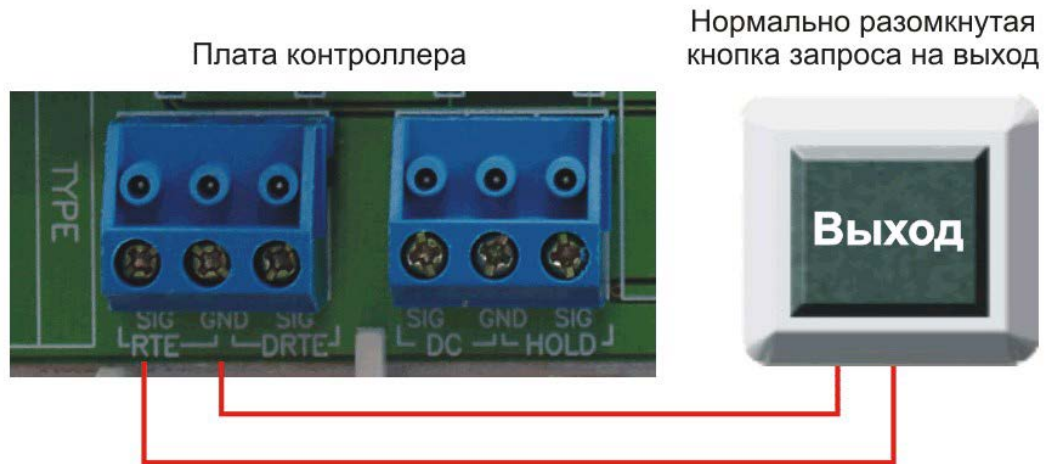
Рисунок 15. Схема подключения кнопки запроса на выход
