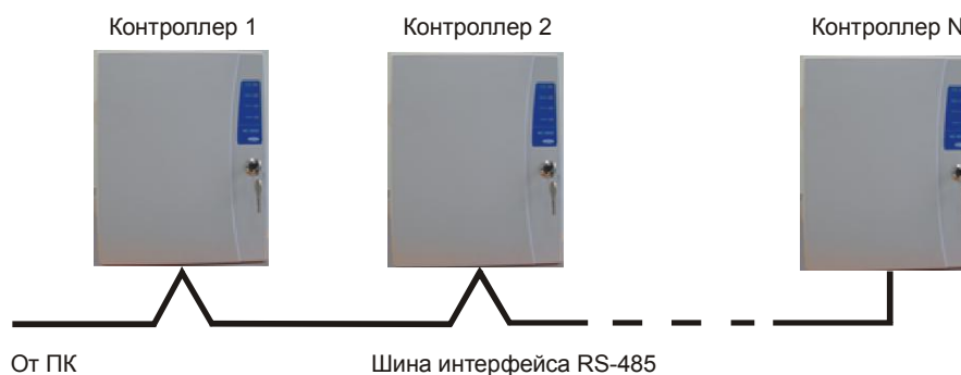
а). Соединение контроллеров по топологии «Шина».
