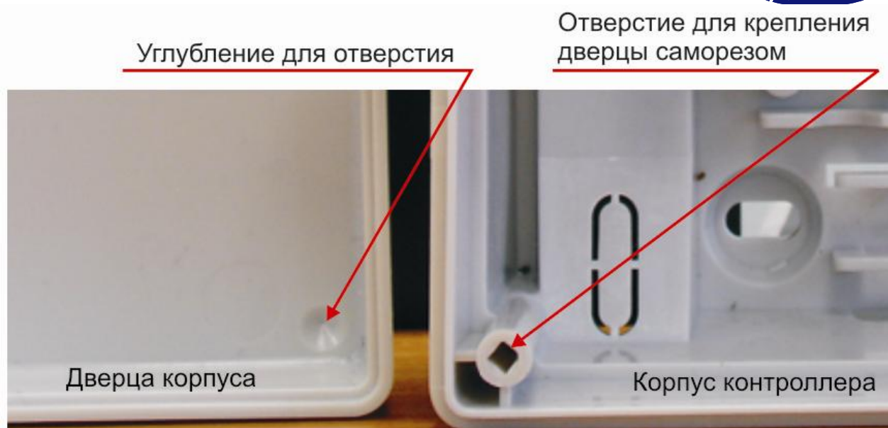
Рисунок 3. Схема «жесткого» крепления дверцы к корпусу контроллера.
