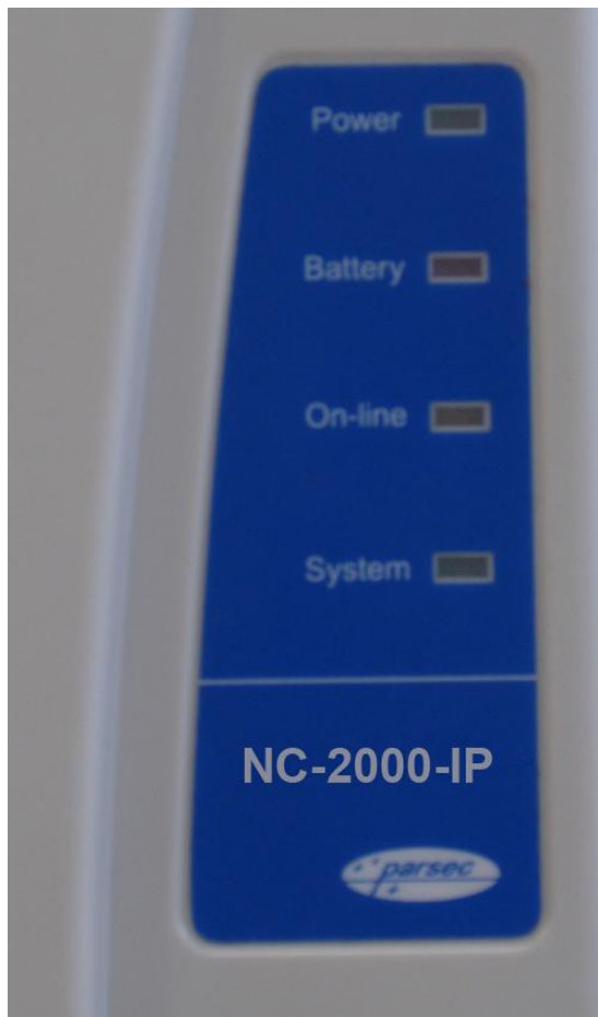
Рисунок 20. Внешняя индикация состояний контроллера.
