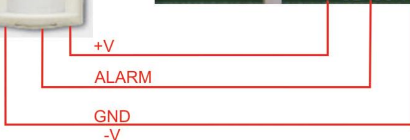
Рисунок 15б. Подключение охранного датчика без контроля подводящих проводов.
