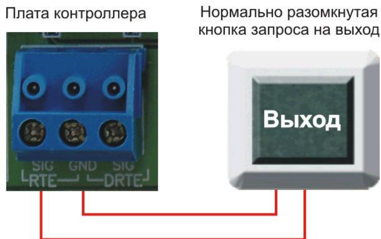
Рисунок 9. Схема подключения кнопки запроса на выход.
