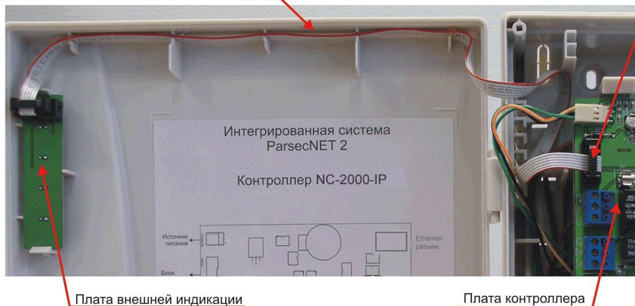
Рисунок 21. Схема подключения платы внешней индикации.
