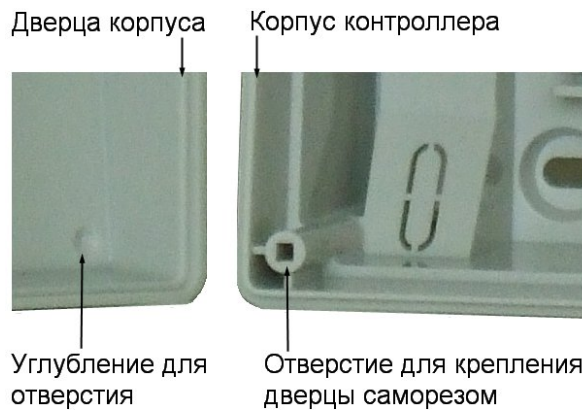
Рисунок 5. Схема «жесткого» крепления дверцы к корпусу контроллера
