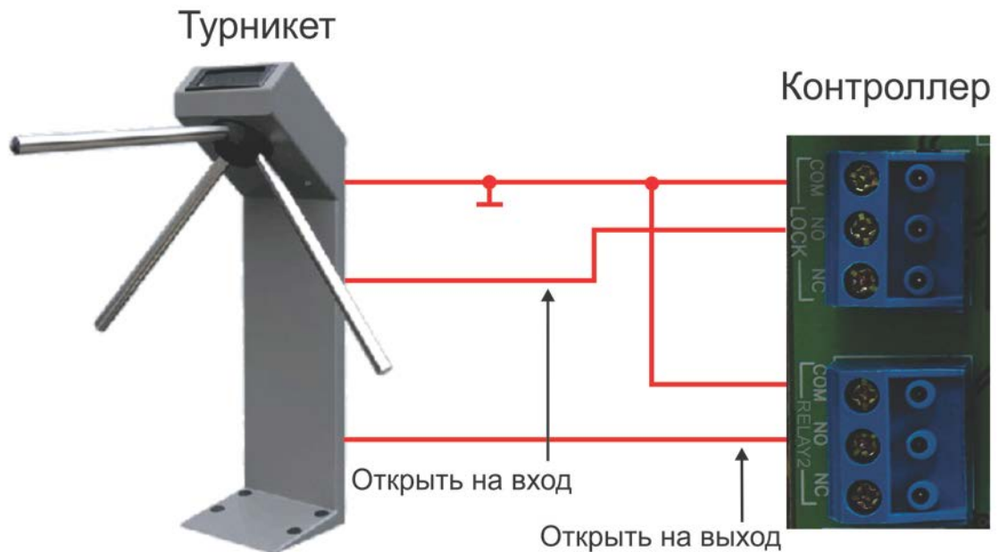
Рисунок 13. Управление турникетом контроллером
