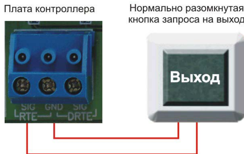
Рисунок 16. Схема подключения кнопки запроса на выход
