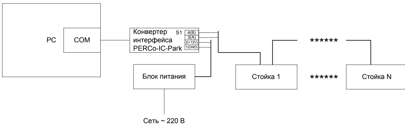
Рисунок А.3 - Подключение парковочных стоек к компьютеру
