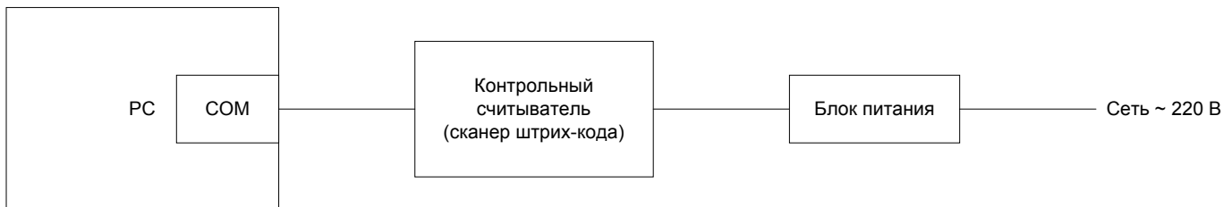
Рисунок А.2 - Подключение контрольного считывателя (сканера штрих-кода) к компьютеру
