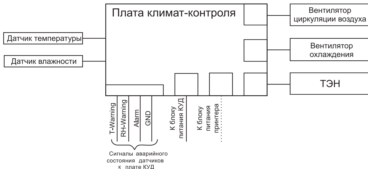
Рисунок 2 - Структурная схема блока климат-контроля
