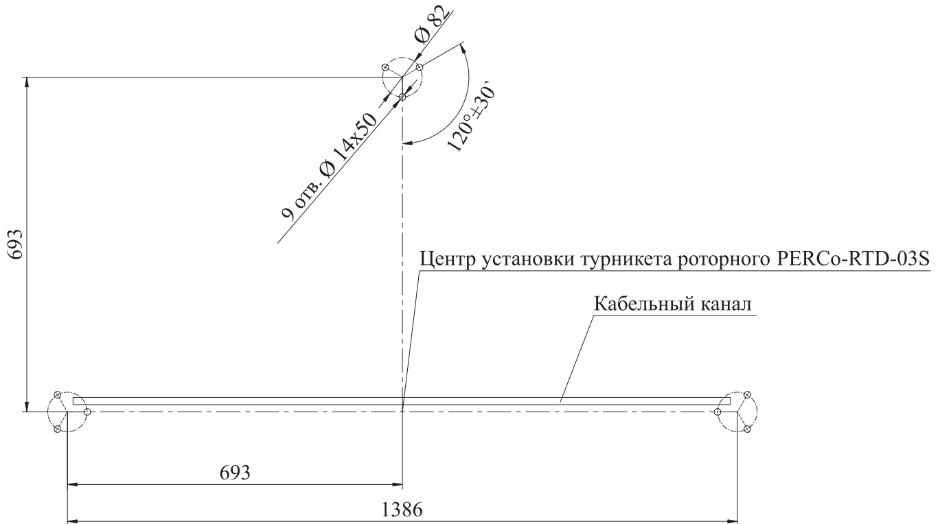
Рис. 3. Разметка для установки стоек формирователя прохода
