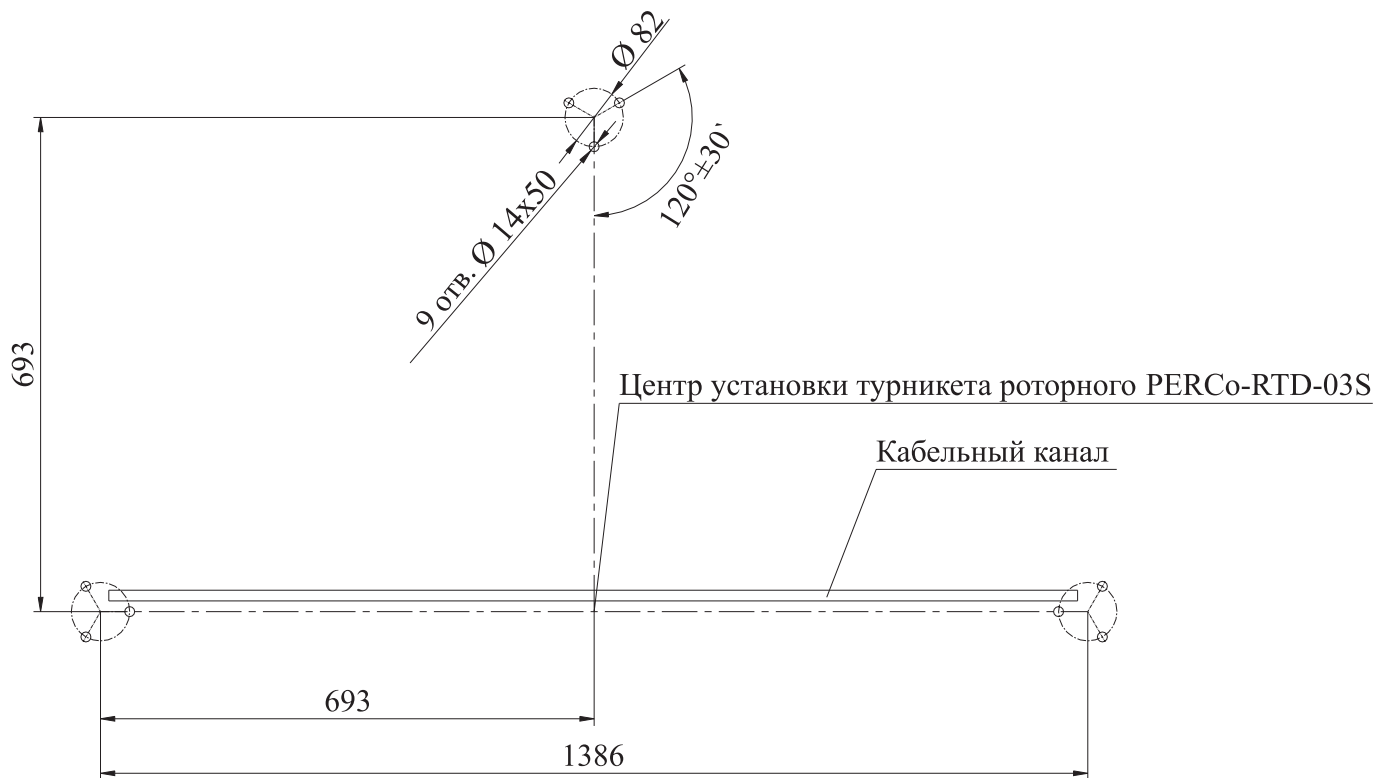
Рис. 3. Разметка для установки стоек формирователя прохода
