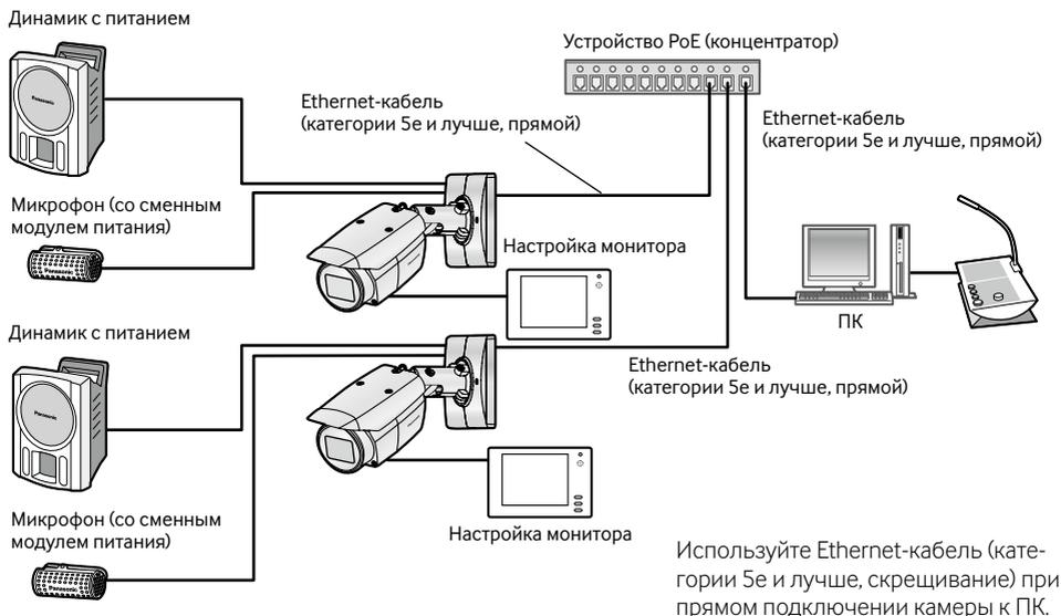
Используйте Ethernet-кабель (категории 5e и лучше, скрещивание) при прямом подключении камеры к ПК.
