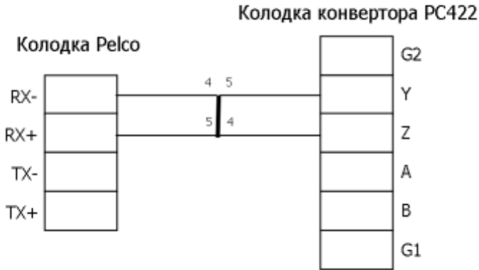
Рисунок 7.4. Схема подключения купольных видеокамер Pelco DD5-M-X через конвертер PC422
