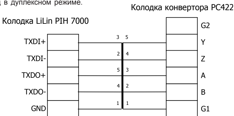
Рисунок 7.3. Схема подключения купольных видеокамер Lilin PIH7000/7600 через конвертер PC422
