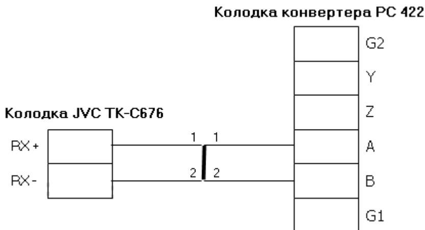
Рисунок 7.10. Схема подключения видеокамер JVC TK-C676 через конвертер PC422
