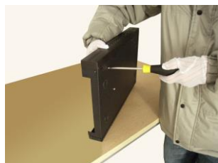
4) Зафиксируйте диск винтами
