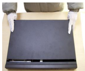
1) Открутите винты, фиксирующие крышку
