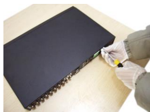
1) Открутите винты, фиксирующие крышку
