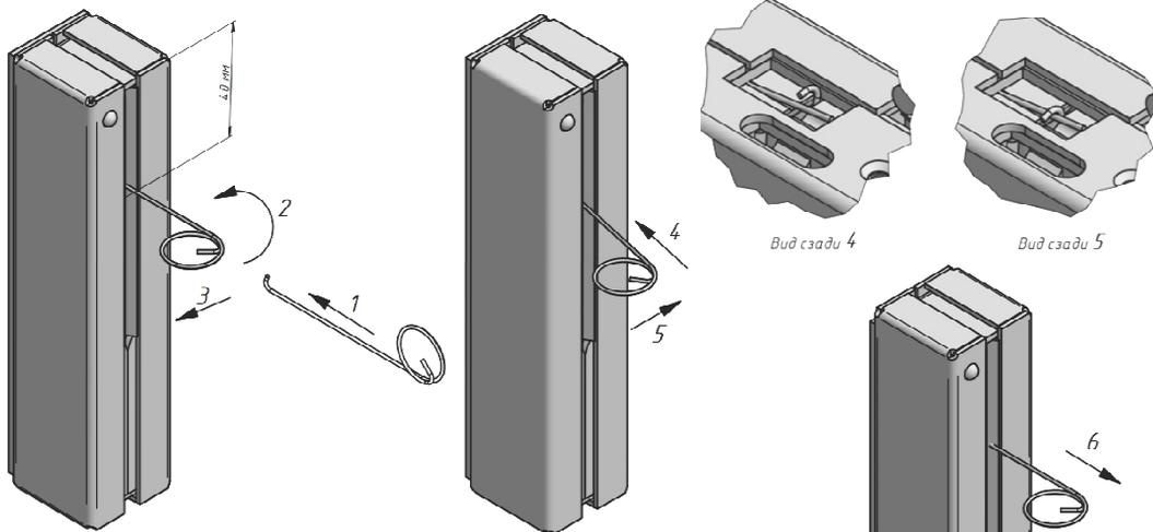
Демонтаж считывателя осуществляется следующим образом:
