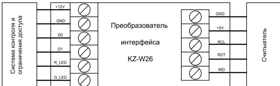
Рис.2. Схема подключения преобразователя интерфейсов
