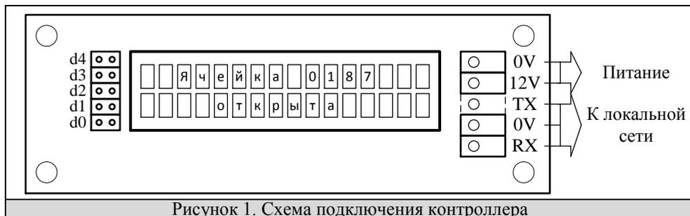
Рисунок 1. Схема подключения контроллера
