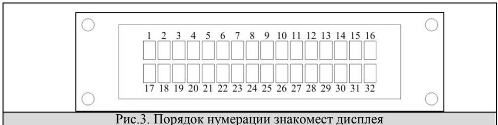
Рис.3. Порядок нумерации знакомест дисплея
