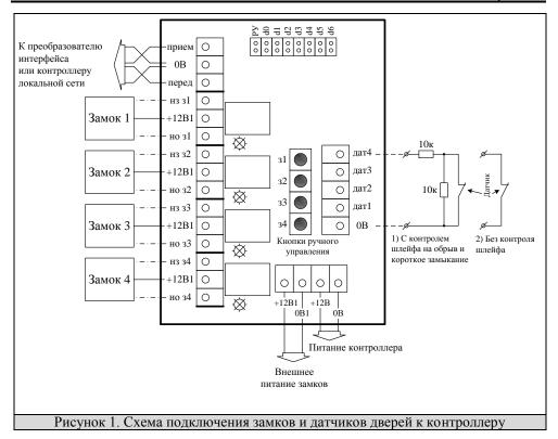
К контроллеру могут быть подключены замки, с напряжением питания 12B, от общего с контроллером источника питания. В этом случае клеммы 0B и 0B1, а также +12B и +12B1 объединяются.
