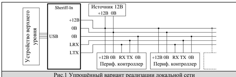
Периферийные контроллеры объединяются клеммами RX(приём)-TX(передача)-0В и подключаются к контроллеру инверсно в клеммы LTX-LRX-0В.
