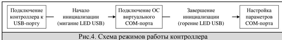
Рис.4. Схема режимов работы контроллера
