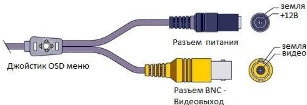
Джойстик OSD меню предназначен для управления переключением режимов работы видеокамеры: AHD/TVI/CVI/CVBS. А также для более детальной настройки видеокамеры.
