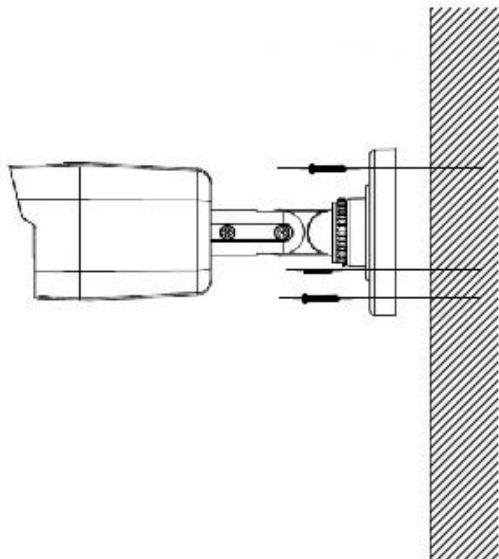
Монтаж камеры может осуществляться как на горизонтальную поверхность, так и на вертикальную. После монтажа на поверхность, настройте ракурс обзора камеры.
