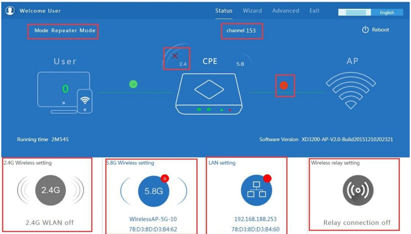
Отображение режима **Repeater mode** в вкладке **Status**
