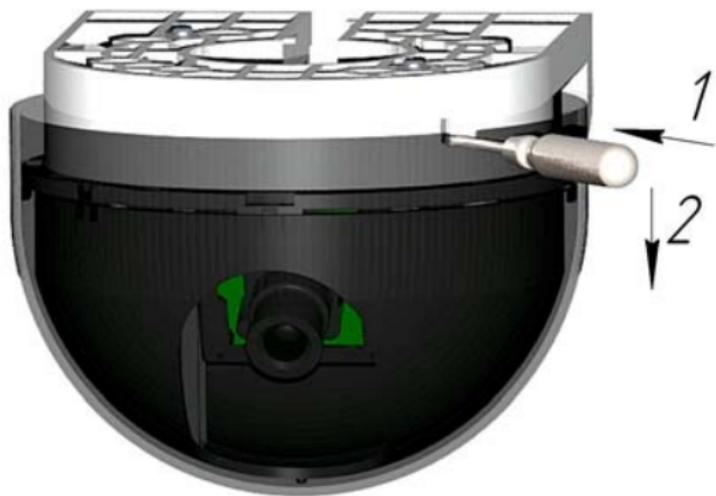
**1** и **2** – направление движения отвертки для разблокирования фиксатора несанкционированного демонтажа КДП.
