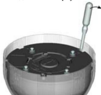
3. Плавным движением отвести отвертку в сторону (по стрелке на рисунке) и разъединить замок. Повторить те же действия для всех замков. Снять купол.
