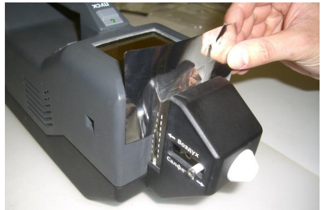
Анализ частиц на пробоотборной салфетке
