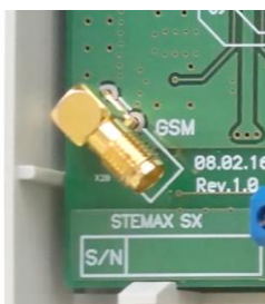
Рисунок 3.1 — SMA-разъем для подключения GSM-антенны
