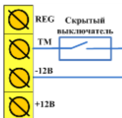
Рисунок 3.2 — Схема подключения скрытого выключателя
