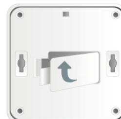
Рисунок 3.2 – Крышка отсека аккумулятора
