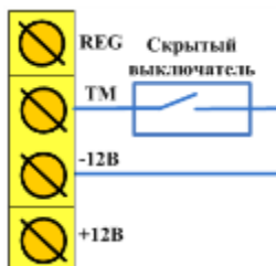
Рисунок 3.4 — Схема подключения скрытого выключателя
