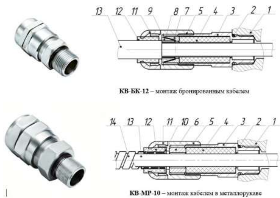
Рисунок 6 – Вводные устройства с двойным уплотнением
