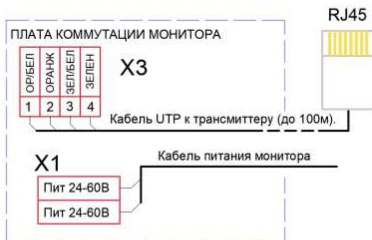
Рисунок 8. Схема подключения монитора с интерфейсом HDMI через трансмиттер.
