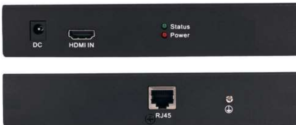
Рисунок 2. Внешний вид трансмиттера с для монитора с выходом HDMI.
