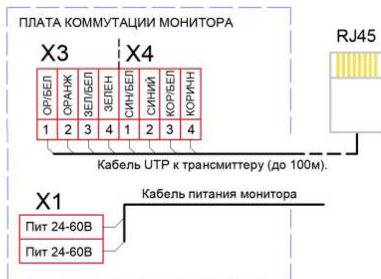
Рисунок 9. Схема подключения монитора с интерфейсом VGA через трансмиттер.
