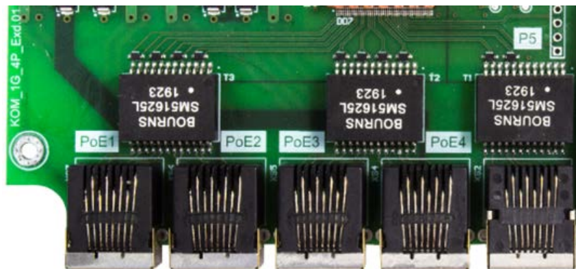
Рисунок 6. Порты Ethernet коммутатора
