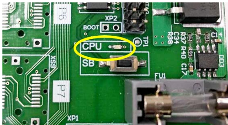
Рисунок 11. Расположение элементов индикации и настройки на плате коммутатора
