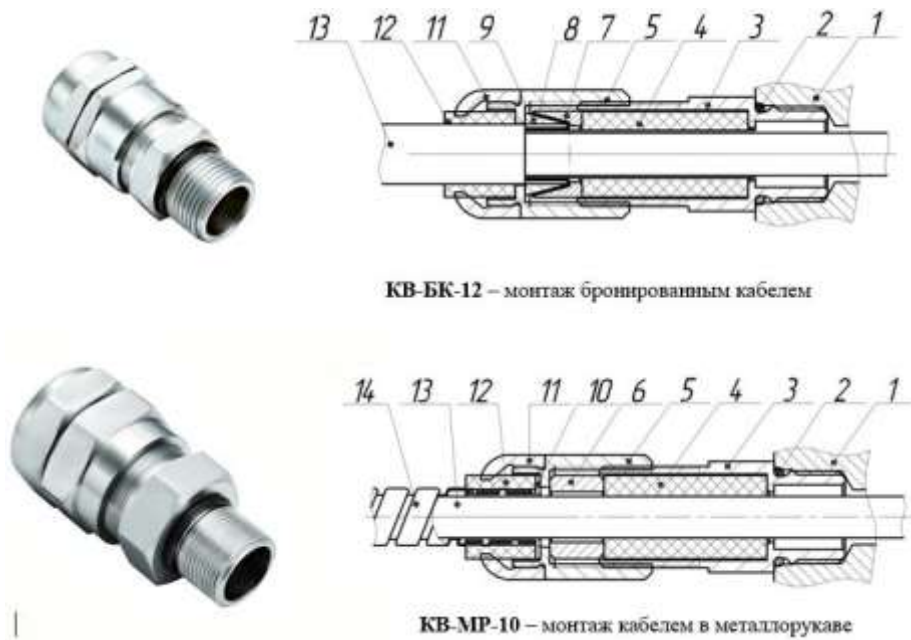
Рисунок 6 – Вводные устройства с двойным уплотнением
