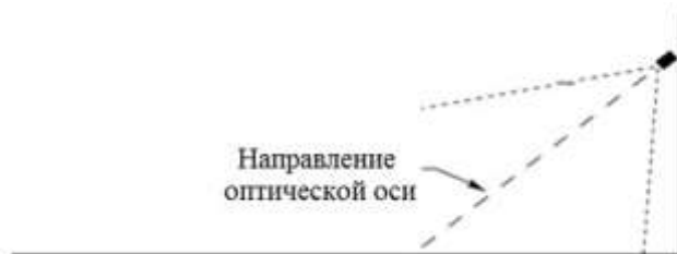
Рисунок 4 – Рекомендуемая установка термокожуха по отношению к горизонту
