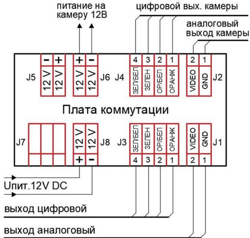
Рисунок 4в – Подключение исполнения 01-210
