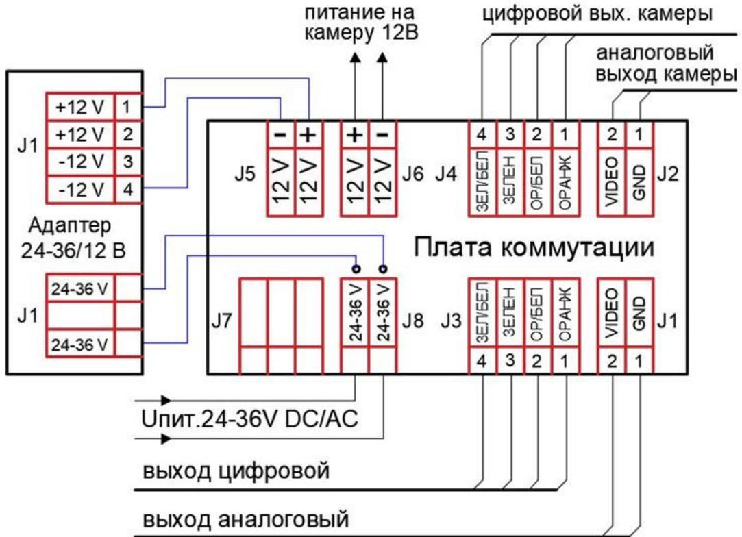
Рисунок 4г – Подключение исполнений 02-210; 03-210
