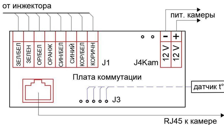
Рис.4е – Подключение исполнений 11-210; 19-210
