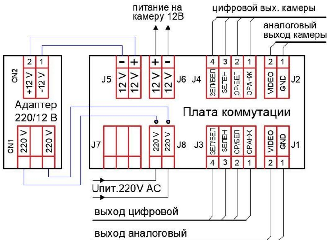
Рисунок 4д – Подключение исполнений 06-210; 07-210
