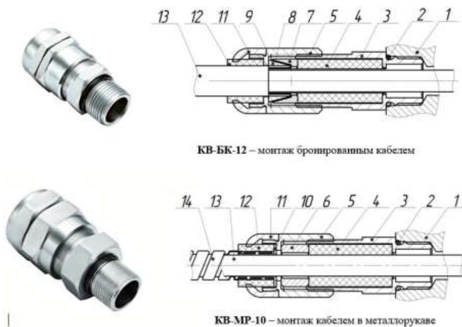
Рисунок 6 – Вводные устройства с двойным уплотнением
