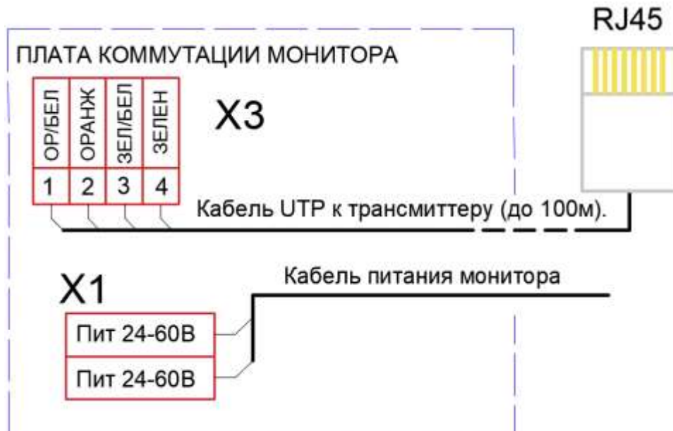
Рисунок 7. Схема подключения ВПУ с трансмиттером
