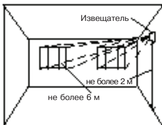
Рис. 28-Установка извещателя на противоположной стене
