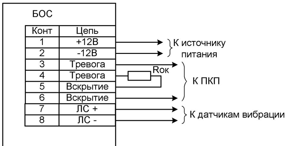
Подключение извещателя с контролем датчика вскрытия отдельным ШС
