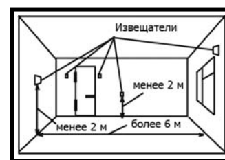
Рис.6. Некорректные варианты установок извещателей
