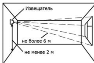
Рис.3. Установка извещателя на противоположной стене
