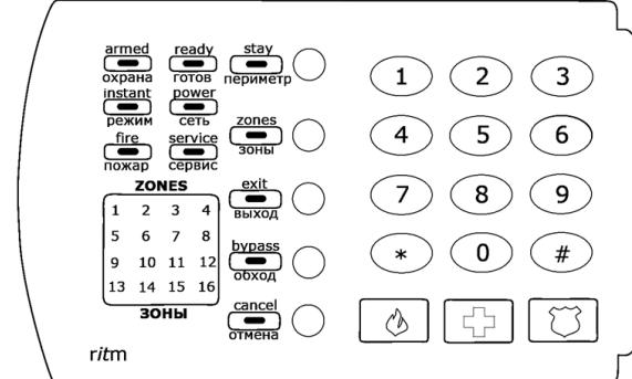
Световая индикация в дежурном режиме дублирует индикацию охранно-пожарной панели «Контакт GSM-10». Для экономии заряда батареи индикация на клавиатуре включается после нажатия любой из клавиш и горит в течение 15 секунд после последнего нажатия.
