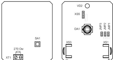
**XT1** — разъём для подключения дополнительного шлейфа сигнализации
