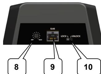
**Важно:** Вследствие того, что напряжение питания подается на консоль через кабель, не допускается изменение порядка следования проводов в разъеме. Неправильная коммутация может привести к выходу из строя всей системы. Не допускается подключение других устройств через это же кабель.
