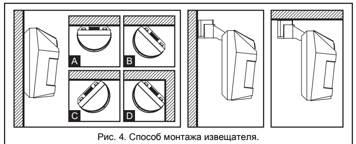
Рис. 4. Способ монтажа извещателя.
