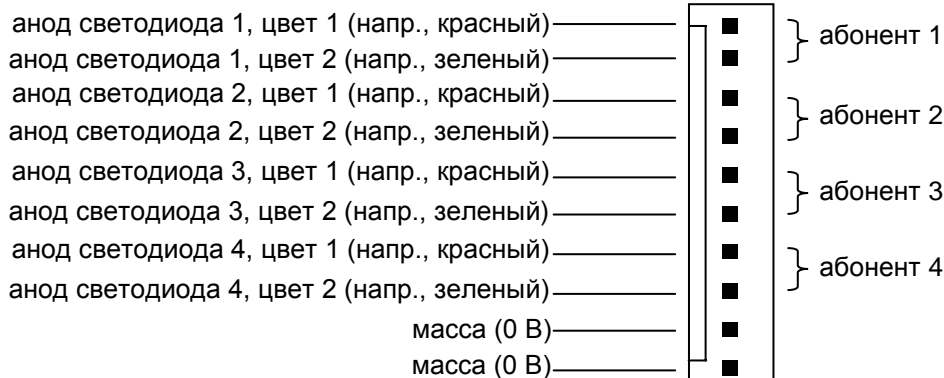
Рис. 6. Способ подключения светодиодов к разъему J1 CA-64 PTSA в случае работы со станцией мониторинга STAM-1.
