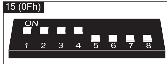
Рис. 18. Способ установки адреса в модуле расширения выходов.
