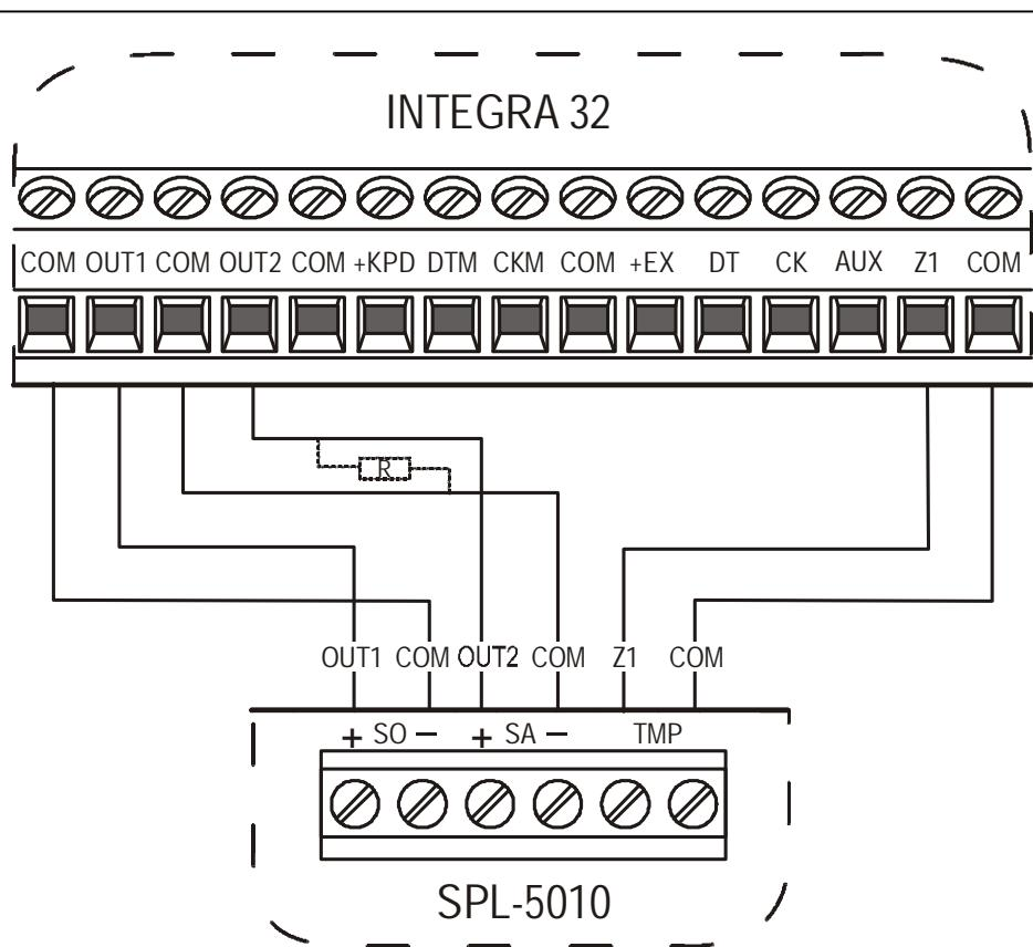
Рис. 2. Способ подключения SPL-5010 к силовым выходам ПКП INTEGRA 32. Выход OUT1 включает оптическую сигнализацию, а выход OUT2 - акустическую (силовые выходы с нормальной поляризацией – включение означает подачу напряжения +12 В). Зона Z1 запрограммирована как 24 ч саботажная.
