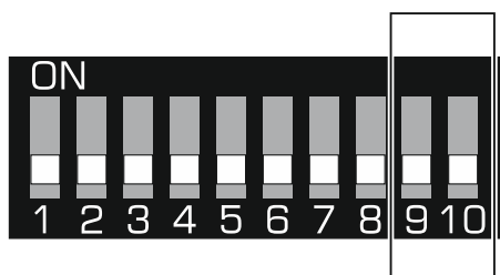
Рис. 2. Переключатели для определения режима работы контроллера.
