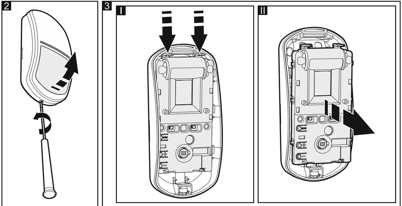
8. Откройте корпус извещателя (рис. 2) и демонтируйте элемент с печатной платой (рис. 3).
