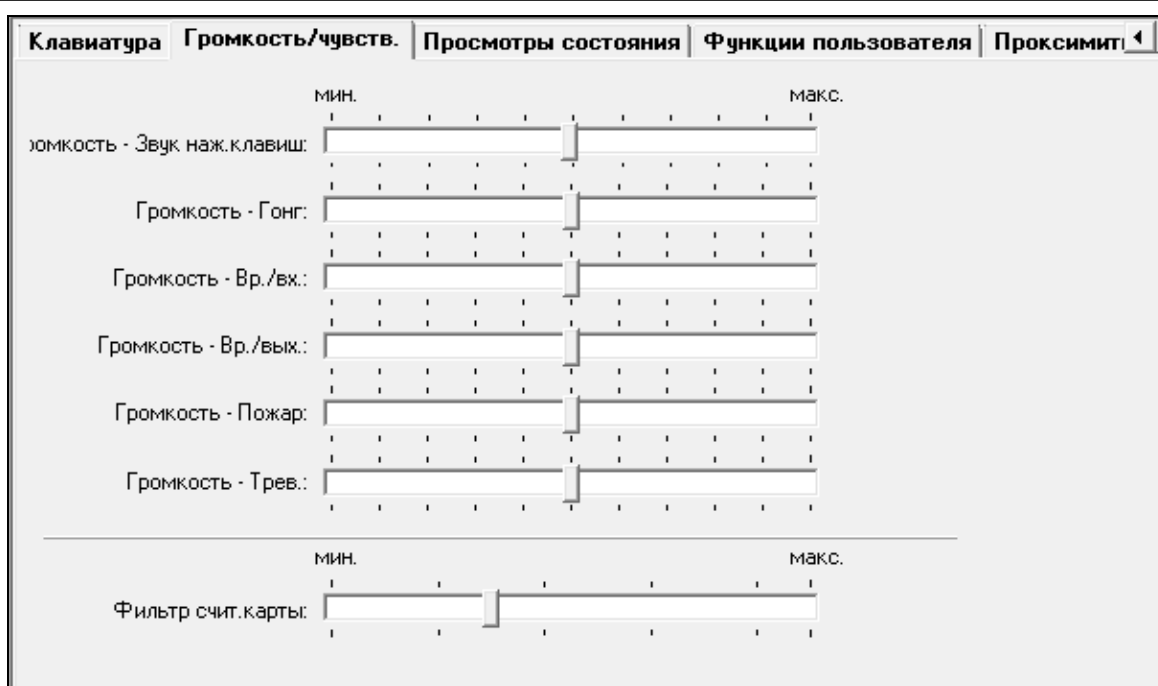
Рис. 6. Программа DLOADX: настройки клавиатуры, хранящиеся в приемно-контрольном приборе – закладка "Громкость/чувствительность".
