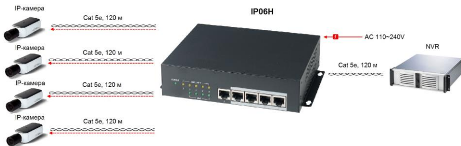
Рис. 5 Схема подключения PoE-коммутатора IP06H.
